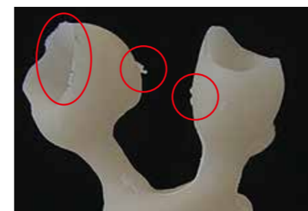
Foto 1 - Formazione di creste causata da crepe nel cilindro
