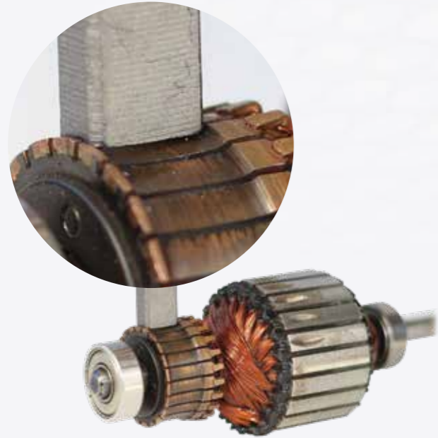
Motor nach 1000 Stunden Laufzeit und konventioneller Ansteuerung
