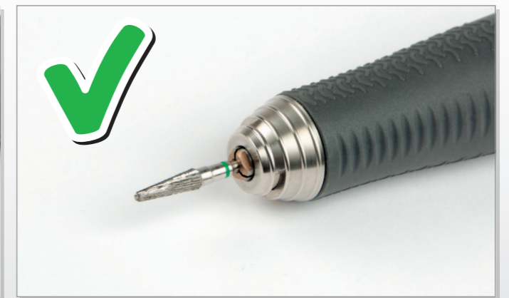
Fräser richtig eingespannt.
