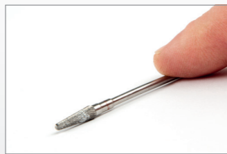
Testen der Rundlaufs durch Rollen auf einer Ebene.
