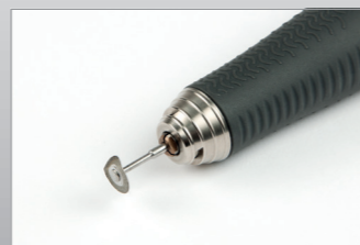
Diamantscheibe gebrochen Ursache: falsches Ablegen des Motorhandstücks auf dem Arbeitstisch, Arbeiten ohne Handstückablage.
