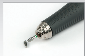
Fräser gebrochen Ursache: Motorhandstück heruntergefallen.
